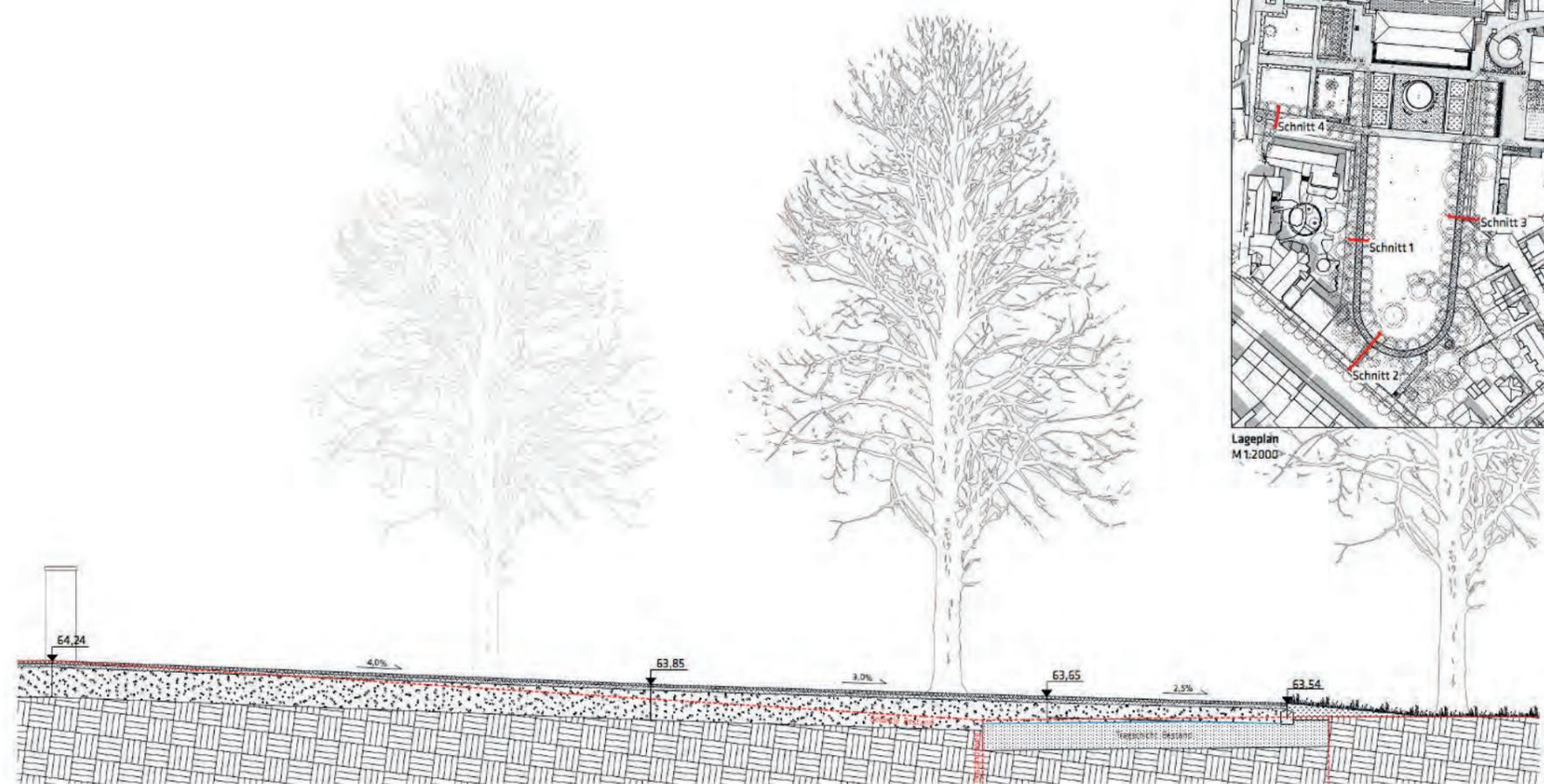
Prinzipanschnitt 2 - Wassergebundene Wegedecke - Bereich Zugang Schlosswall
